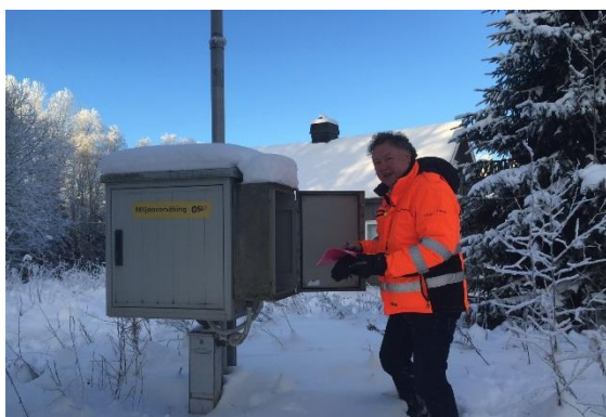
Oslo lufthavns støy- og traséovervåkingsanlegg registrerer støynivået kontinuerlig på 11 punkter rundt flyplassen
