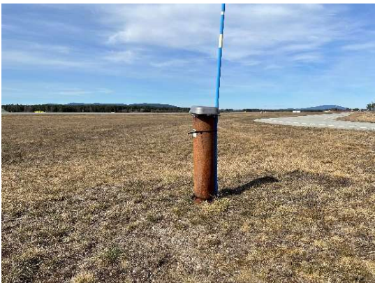
Overvåkningsbrønn for grunnvann
